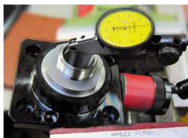
Inspección del Extremo de Salida
