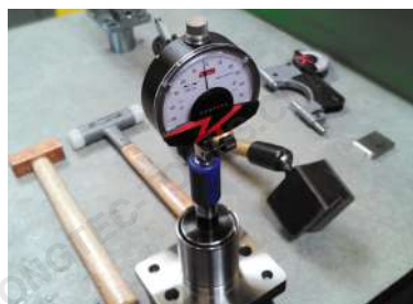
Inspection de l'extr mit  d'entr e
