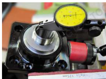
Inspection de l'extr mit  de sortie
