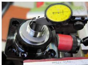
Inspeção da Extremidade de Saída
