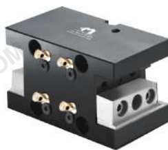
Двойные статические держатели инструментов для наружной обработки (OD)
